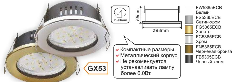
У встраиваемых светильников степень защиты IP65 с фронтальной стороны. Оснащены двумя резиновыми прокладками — под стеклом и по краю, который прилегает к установочной поверхности.
